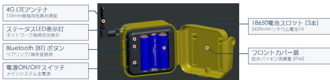
図 2.2: カメラ内部写真各部名称 (ステータス LED、BT ボタン、電源スイッチ & 電池トレイ)
